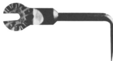
Dégoupilleur pointe fine — Fine-point type
