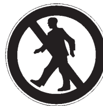
Bild 1: "Für Fußgänger verboten" Sicherheitszeichen DIN 4844-V3
