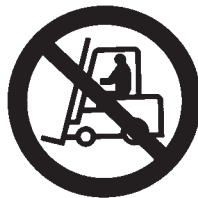
Bild 4: "Für Flurförderzeuge verboten" Sicherheitszeichen DIN 4844-V7
