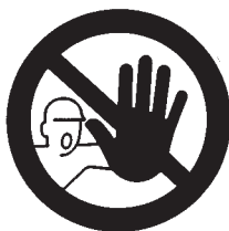
Bild 5: "Zutritt für Unbefugte verboten" Sicherheitszeichen DIN 4844-V10
