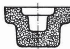
Bild 4. Gußteil: Ohne Faserverlauf
