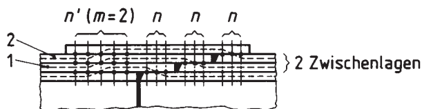
Bild 3. Erhöhung der Anzahl der Verbindungsmittel bei mittelbarer Stoßdeckung
