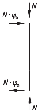
Bild 7. Ersatzbelastung für eine Vorverdrehung \varphi_0
