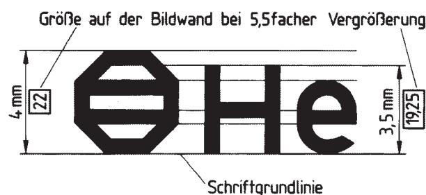
d) Projizierte Schrift, Versalhöhe \frac{6}{7} der Schlüsselhöhe des ISO-Testzeichens Nr 1, entspricht 18,85 mm. Gewählt 19,25 mm (entspricht einer Schriftgröße von 3,5 mm, Versalhöhe einer Grotesk-Druckschrift bei 5,5facher Vergrößerung mit (Winkel-)Minutenraster für Betrachtungsabstand e_{\max} = 9 \text{ m} )
