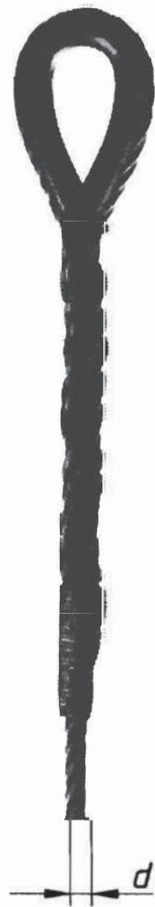
Bild 6. Gespleißt mit Kausche (SKF)
