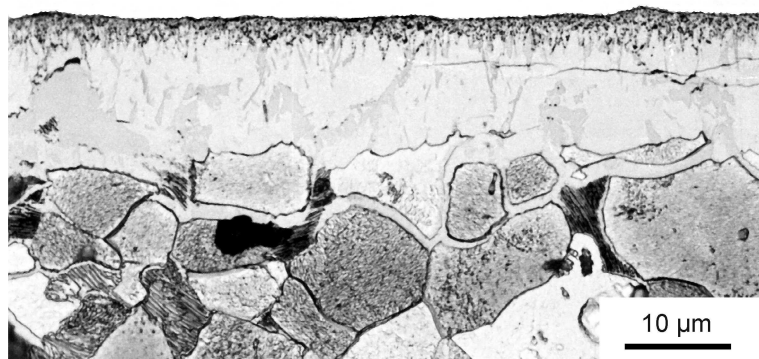
Bild 1 — Verbindungsschicht mit geringer Porosität (geätzt mit Nital)
