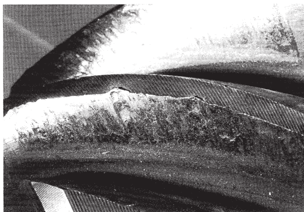
Bild 9. Starkes Fressen an einem spiralverzahnten einsatzgehärteten Kegelrad (Vergrößerung ca. 1,6fach)
