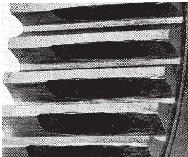
Bild 13. Passungsrost an den Zahnflanken einer Zahnkupplung (Verkleinerung ca. 0,5fach)
