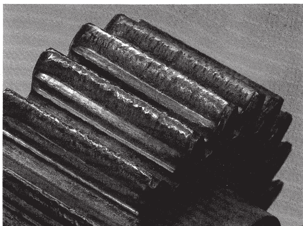
Bild 16. Durch mangelhafte Schmierung in Verbindung mit starkem Fressen ausgeglühtes Geradstirnrad
