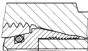
Bauart-Nr 11 O-Ring konisch dichtend für Bohrungsform W nach DIN 3861
