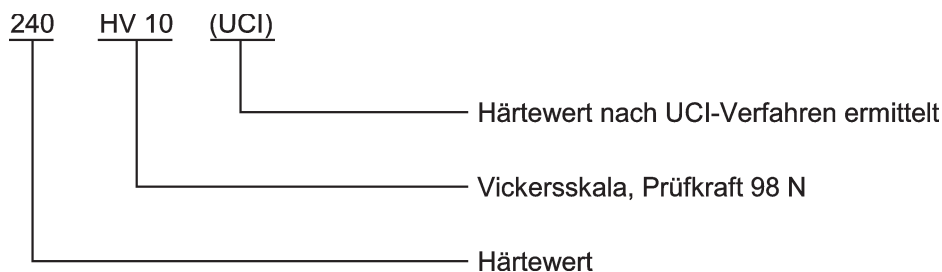
Bild 1 —Beispiel für die Angabe der Härte nach dem UIC-Verfahren
