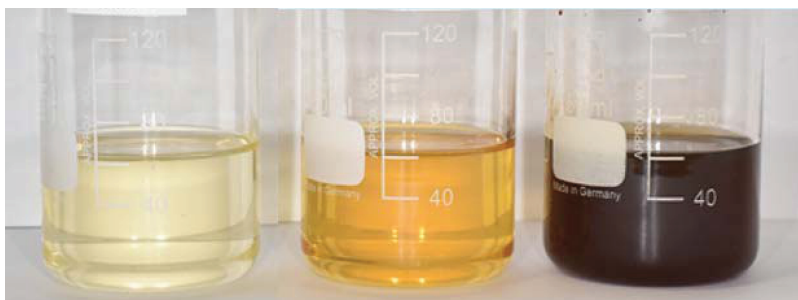
Bild 1 — Beispielfoto für Bechergläser nach thermischer Behandlung
