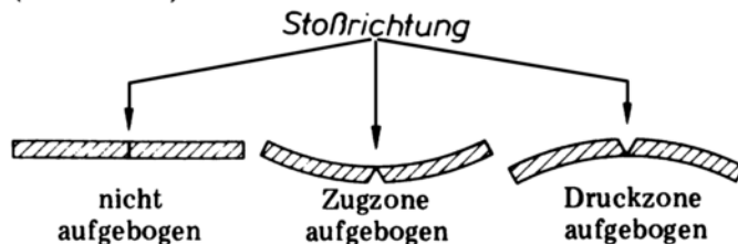
Bild 2. Beispiel für die Schädigung beim Durchriß
