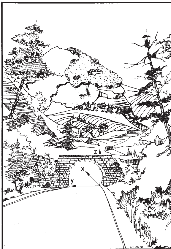
Bild 1. Beispiel für die Lage eines rechtwinkligen Koordinatensystems an der Tunneleinfahrt
