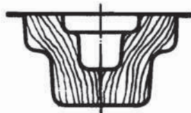
Bild 1. Im Gesenk von der Stange geschmiedet: Günstiger Faserverlauf
