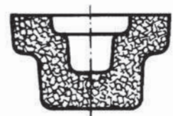
Bild 4. Gußteil: Ohne Faserverlauf
