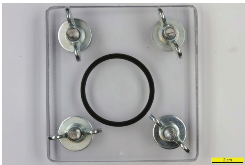
Bild 4 — Zusammendrücken des O-Rings mit 4 Schrauben
