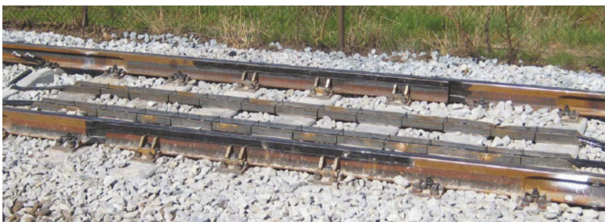
Bild 13 — Schienenauszug bei Schotteroberbau
