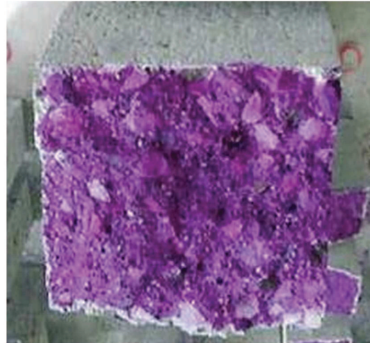
Bild 1 — Phenolphthalein-Indikator, aufgebracht auf eine soeben freigelegte Oberfläche eines qualitativ hochwertigen Betons
