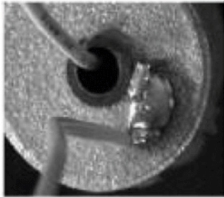
Bild 2 – Anschluss an der oberen Seite des Kondensators
