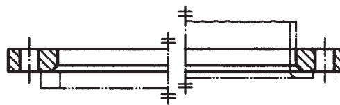
Typ 02 Loser Flansch für glatten Bund (siehe Typ 32) oder für Vorschweißbördel (siehe Typ 33)
