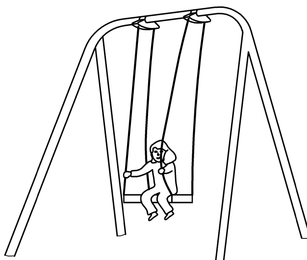
Bild 2 — Beispiel einer Schaukel mit mehreren Drehachsen (Typ 2)
