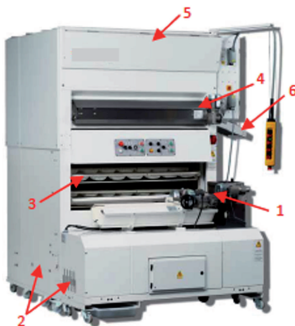
c) Beispiel eines Zwischengärschranks mit automatischer Beschickung
