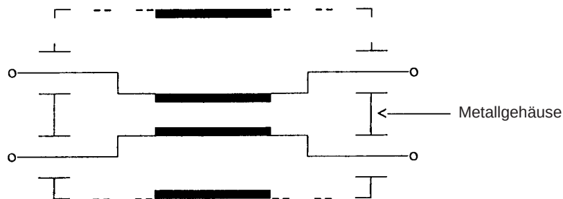
Bild 4c: Mehrfach-Durchführungskondensator (nichtkoaxial) für symmetrische und asymmetrische Anwendung
