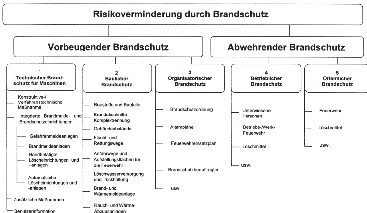
Bild 1 — Risikoverminderung durch Brandschutzmaßnahmen
