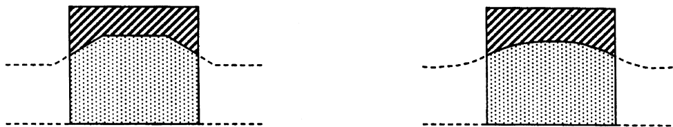
Bild A.2 — Beispiele für Probekörper mit geformten Füllstücken
