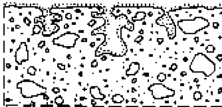
Bild 1 — Schematische Darstellung einer hydrophobierenden Imprägnierung
