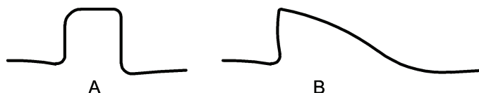
Bild 2 — Beispiel einer Signalform eines guten (A) und eines schlechten (B) Schwefelkohlenstofflösemittels 1)
