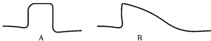
Bild 2 — Beispiel einer Signalform eines guten (A) und eines schlechten (B) Schwefelkohlenstofflösemittels, erhalten unter kryogenen Bedingungen
