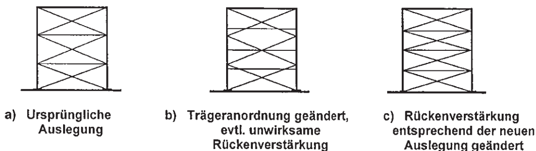
Bild 2 — Änderung der Trägeranordnung kann Änderung der vertikalen Aussteifung erforderlich machen
