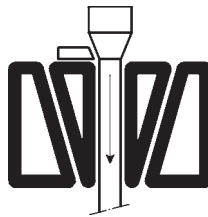
Bild 3 — Slip-Type-Elevator mit Slips und setting ring
