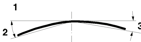
Bild 4 — Beispiel der Winkelmessung bei einfach geneigten, kippbaren Sitzen
