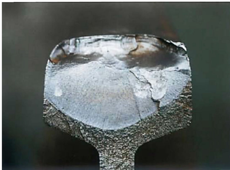
Bild A.3 — 411 – innerer Fehler des Kopfs in der Schweißnaht
