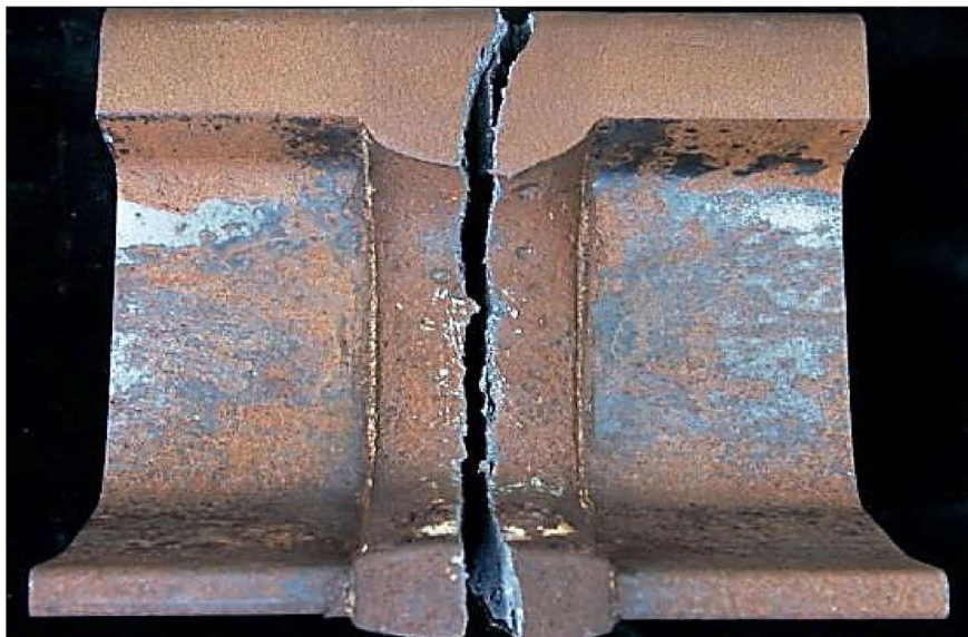
Bild A.5 — 421 – Riss größtenteils in der vertikalen Ebene
