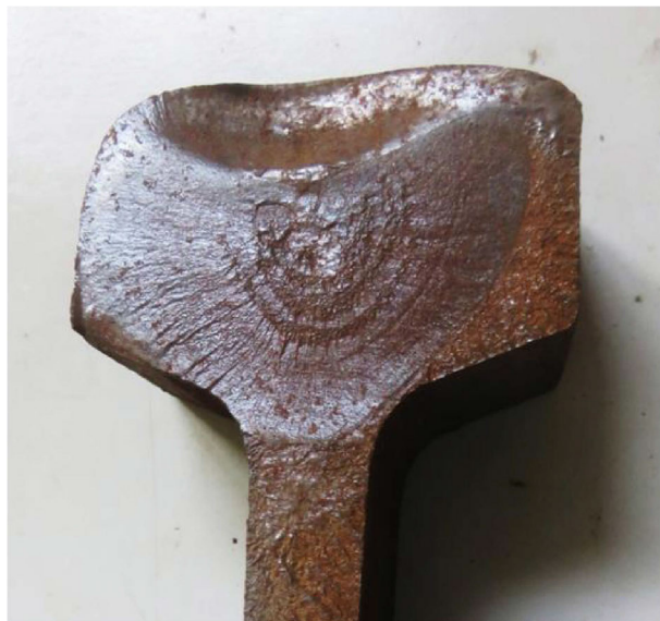
Bild A.1 — 211 - Zentraler Ursprung
