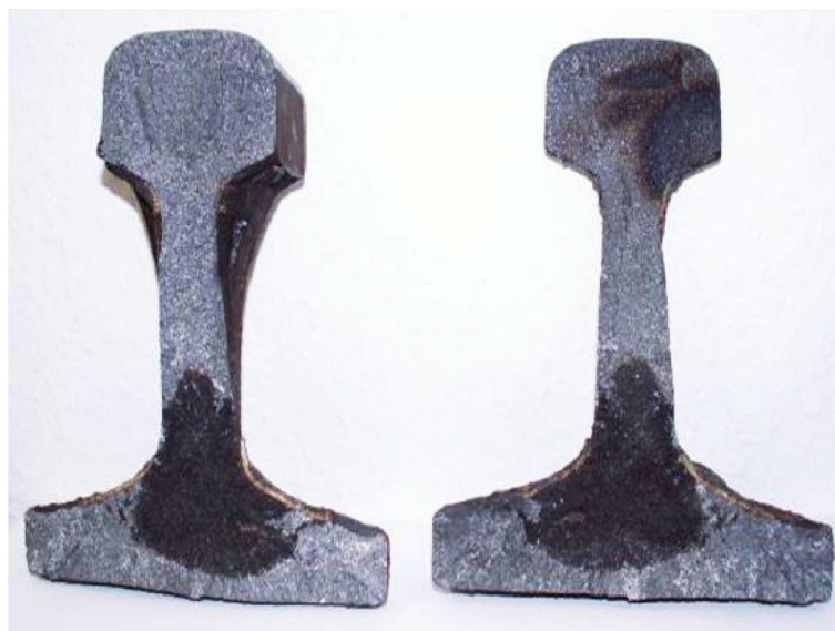
Bild A.6 — 421 – Bruch durch Riss in der vertikalen Ebene in der Schweißnaht
