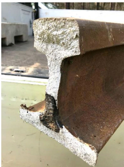
Bild A.4 — 421 – innerer Fehler des Fußes in der Schweißnaht
