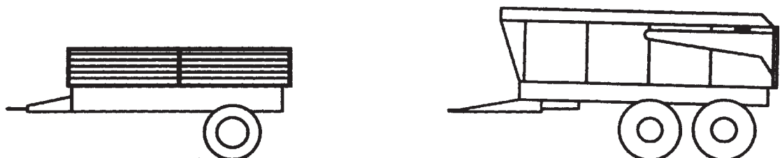
Bild 2: Beispiele für Starrdeichsel-Anhänger
