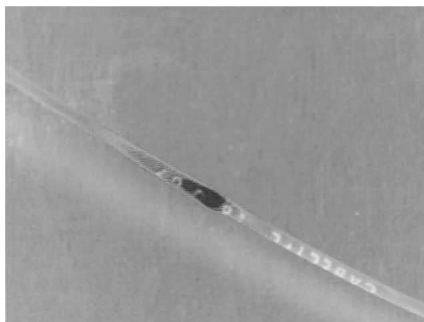
Bild 2 — Durch ein Suchgerät für sichtbare Fehler lokalisierter Bruch
