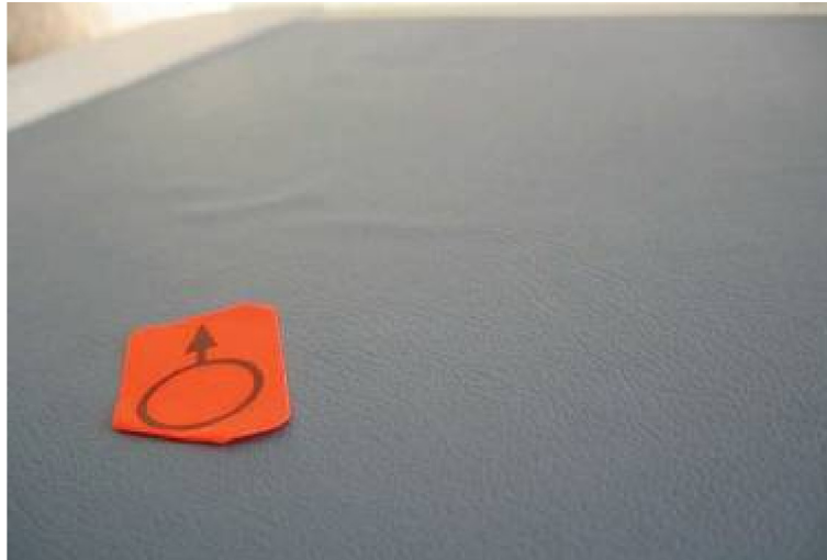
Bild A.7 — Beispiel für mangelhaftes Anhaften
