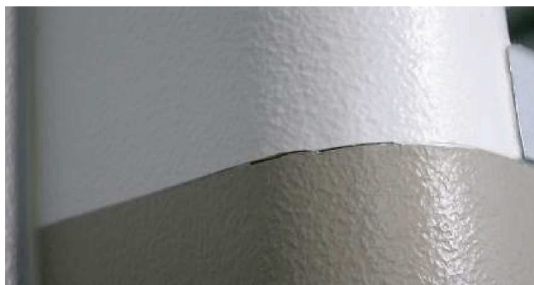
Bild A.11 — Beispiel einer unebenen Trennfuge
