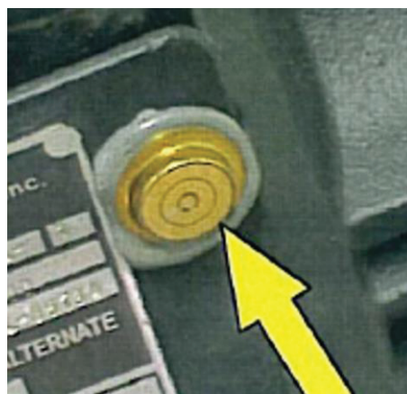
Bild 3 — Klebstoff aus Harz zum Befestigen eines CMB-Tags
