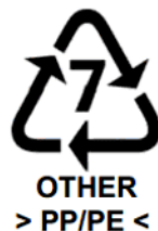
Bild 2 — Kennzeichnung von Batteriekomponenten aus Polypropylen-Polyethylen-Copolymer
