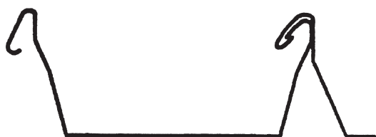
Bild 7: Typisches Profil mit Stehfalz
