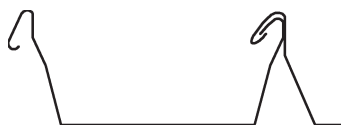
Bild 7 — Typisches Profil mit Stehfalz
