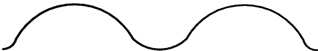
Bild 6 — Teil eines typischen Wellblechprofils
