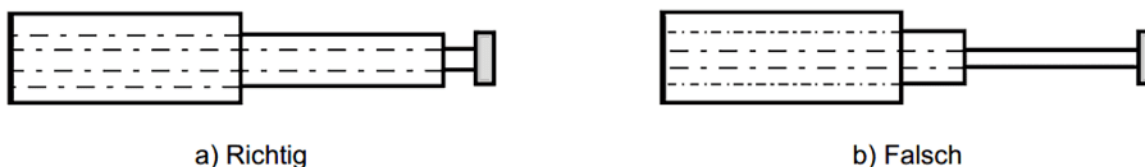
Bild 2 – Einstellung einer Teleskopantenne auf die Länge L_{we}
