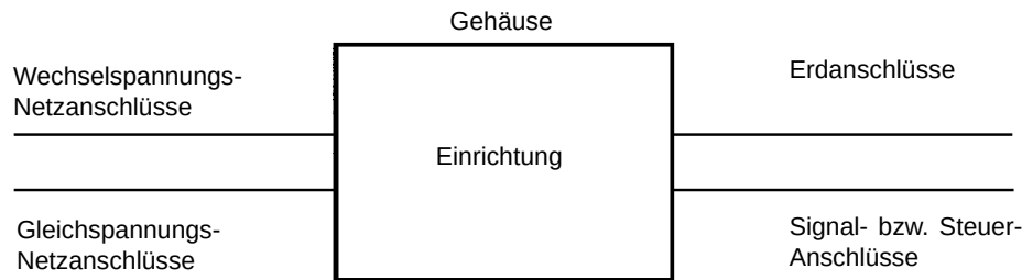
Bild 1: Beispiele von Anschlüssen (Toren)
