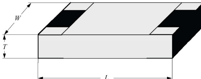
Bild 1 – Form und Maße von rechteckigen (RR-)Widerständen
