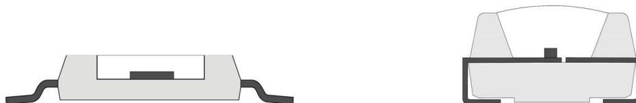
Bild 1 – Beispiele zu LED-Packages
