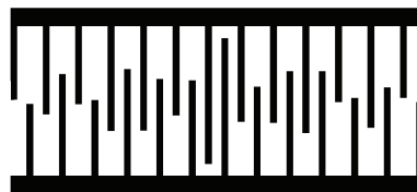
Bild 6 – Überlappungswichtung durch Variation der Fingerüberlappung
