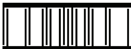
Bild 7 – Ausdünnungswichtung durch selektives Entfernen von Fingern
