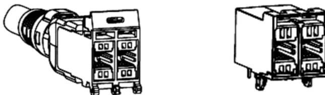
Bild 1 – Isometrische Darstellung von festen Steckverbindern für Kabel und für Leiterplatten
