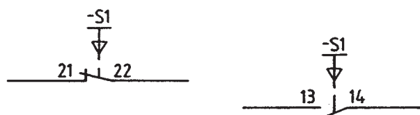
Bild 10: Beispiel für einen handbetätigten Schalter in vereinfachter wiederholter Darstellung
