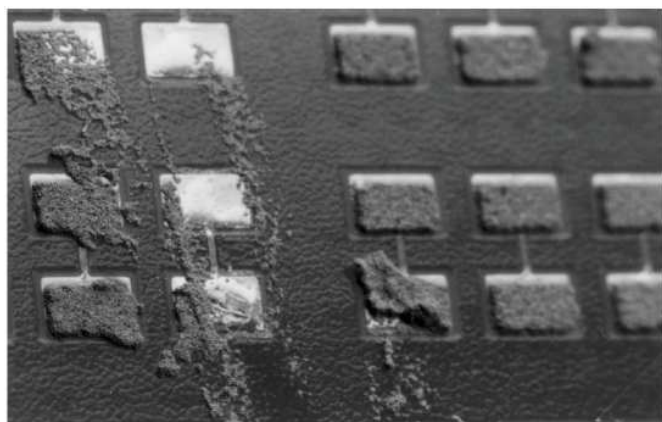
Bild 5 – Verschmierte Lotpaste – Unzulässig
