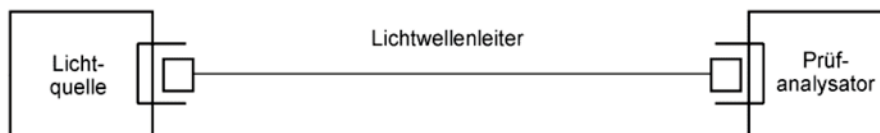
Bild 1 – Prüfaufbau unter Verwendung eines Gaslasers mit bekannter Wellenlänge
