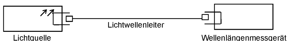
Bild 1 – Messaufbau für die Kalibrierung der Wellenlänge
